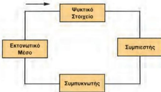
Σχήμα 5.1 Τα κύρια μέρη του ψυκτικού κύκλου
